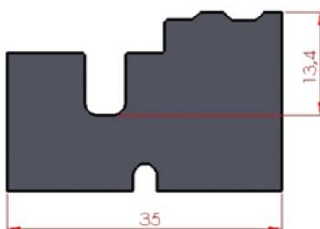
**Application:** plaquettes profilées en carbure de type Leitz pour usage universel, pour bois naturel, outillage de fenêtre.
